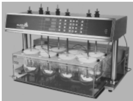
Рис. 4.5. Установка для тестирования на растворение таблеток и капсул производства PharmaTest (Германия), модель PTWS 3CE
